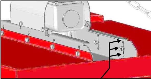
Ajuste de altura de corte con 3 posiciones por desplazamiento del bloque soporte engranaje gran ángulo
